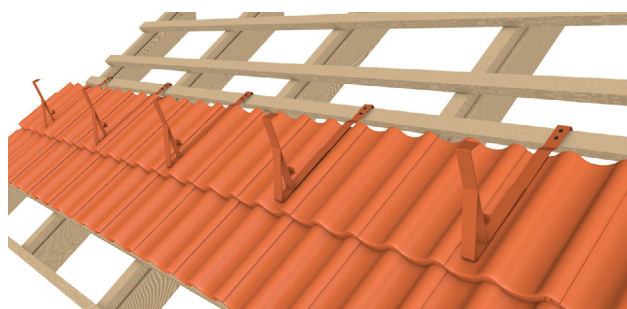
Přídavná lať 40/60, 3x vrut \varnothing 5 mm
