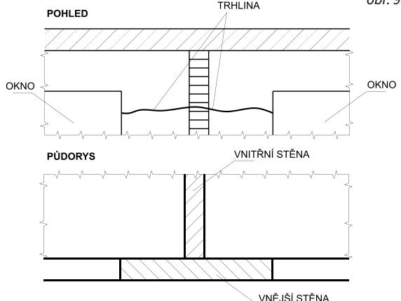
Trhlinky v důsledku rozdílů v tvarových změnách ve vertikálním směru, vnější stěna se zkracuje oproti vnitřní
