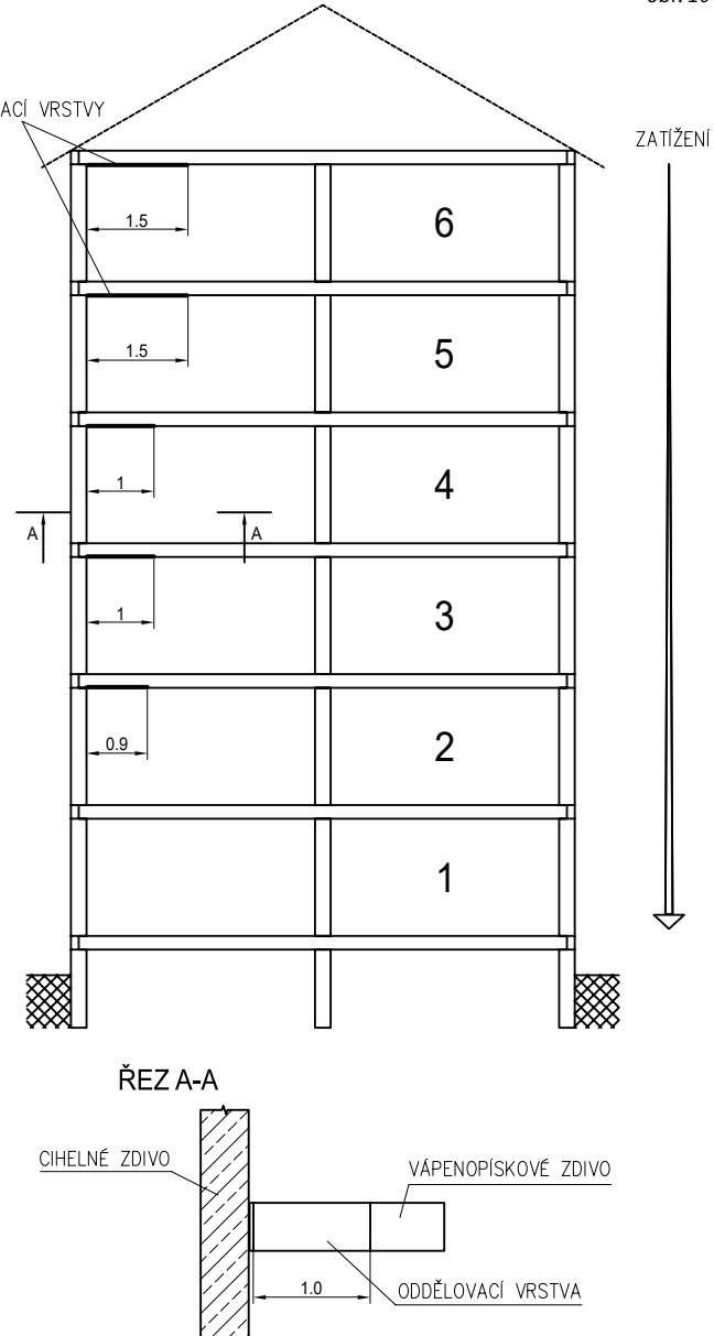
Technika tupého spoje i vložené oddělovací vrstvy ve vnitřní stěně
