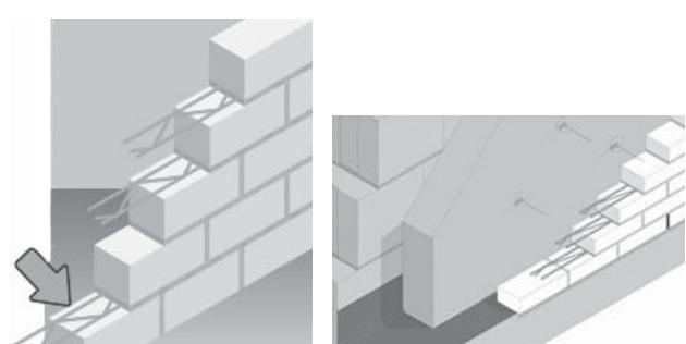
Namáhání stěn, které je možné vyřešit vložením výztuže do ložné spáry zdiva:
