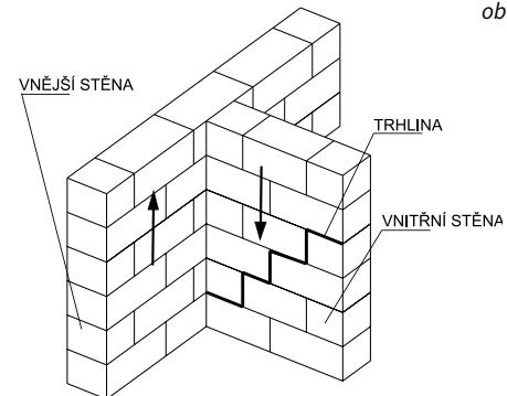
Trhlinky v důsledku rozdílů v tvarových změnách ve vertikálním směru, vnitřní stěna se zkracuje oproti vnější
