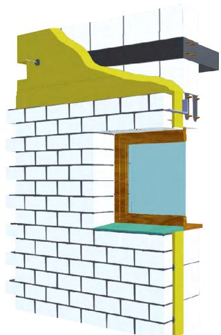
Na rozdíl od předchozích kontaktních zateplovacích systémů, kde vždy dochází alespoň k omezené kondenzaci vodních par, je Tento systém difuzně zcela ideální skladbou. To je však vykompenzováno poněkud vyšší tloušťkou celé konstrukce, kterou zvyšuje vzduchová mezera a 115 mm nebo 71 mm široká přízdívka.
