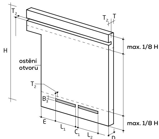
4. U stěn tloušťky větší než 115 mm smí být přípustná hloubka drážky T2 zvětšena o 10 mm, jestliže je strojem vyřezávána přesně na požadovanou hloubku. Je-li použito strojní vyřezávání drážek, smějí být hloubeny drážky na obou stranách stěny o hloubce 10 mm jen v případech, kdy tloušťka stěny není menší než 225 mm.
